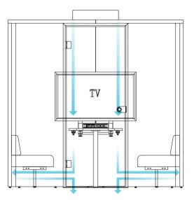
通风循环示意图 Ventilation cycle diagram
