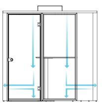
通风循环示意图 Ventilation cycle diagram
